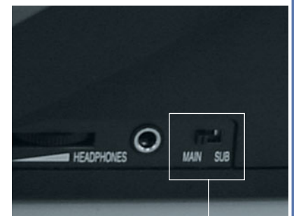
• Селектор канала вещания пульта TS-902
